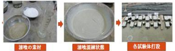
図1 漆喰試験体の製造方法
